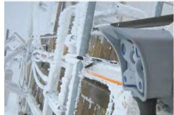
(DWD) auf dem Zugspitzgipfel, wo ein Online-Anschluss nicht möglich ist. Deshalb wurde dort ein Mini-Netzwerk aus einem Linux-Rechner und der Kamera aufgebaut, die kontinuierlich das Auftreten der Bannerwolken zu dokumentieren. Tagsüber wird alle 5 Sekunden ein jpg-Bild abgespeichert. Nachts erzeugt der Rechner aus den Einzelbildern einen mpeg-Film, der dann im Institut ausgewertet wird.
