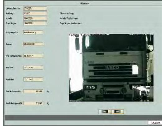
Die Fahrzeuge auf den Waagen werden automatisch registriert ...
